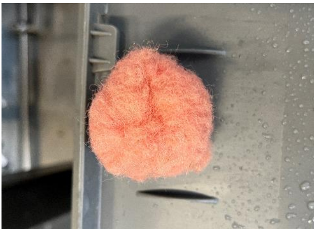
Abbildung 4-3: Filtermaterial des Flexbed Filters: Faserball aus gezogenen PPS-Fasern, mit Clips zu einem Ball gebunden (Ø ca. 30 mm)
